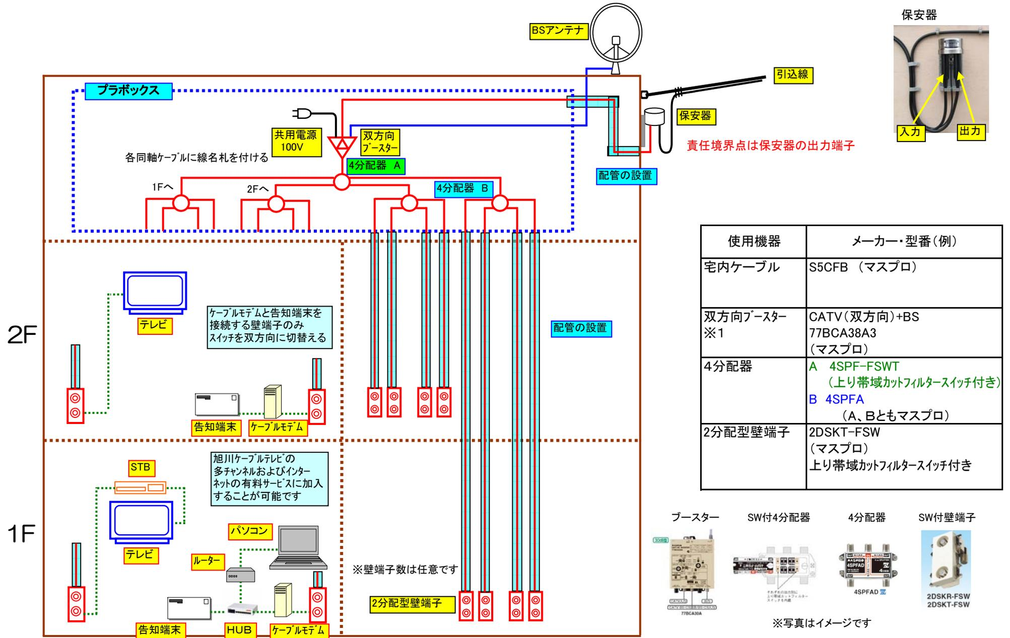
※1 ①出力は施設規模に応じて機種選定が必要。分配・配線規模により減推量異なります。②地上デジタル放送信号の壁面端子レベルはCATV技術協会により57～81dB $\mu$ vが推奨値。これは壁面端子とテレビ(チューナー)間に、レコーダー等の機器を接続しても対応できるレベルです。③保安器出力は、65～78dB $\mu$ v程度で出力されます。
